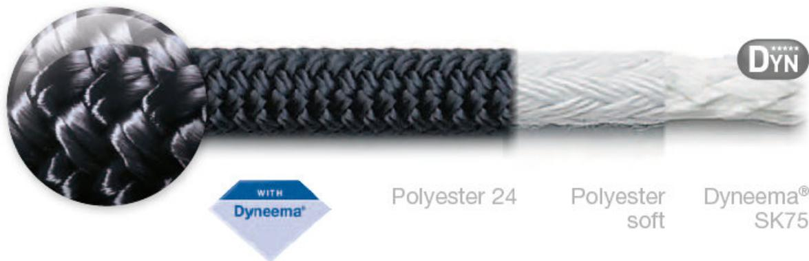
Die Globe 3000 ist aufgrund des unterschiedlich geflochtenen Mantels etwas weicher als die Globe 5000 und der Anteil an Dyneema® SK75 ist verringert. Die Kernimprägnierung und der PESSoft-Zwischenmantel sorgen auch bei dieser Leine für gute Spleißbarkeit und Schutz im abgestrippten Zustand. Einsatz findet die Globe ebenfalls vom Fall über die Schot bis hin zur Trimmleine.
